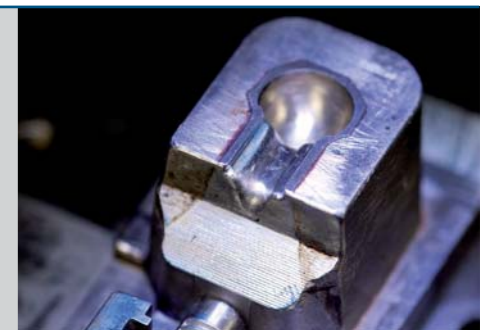
Die insert for an injection mould (Photo: Grübel KG, Tabarz)
